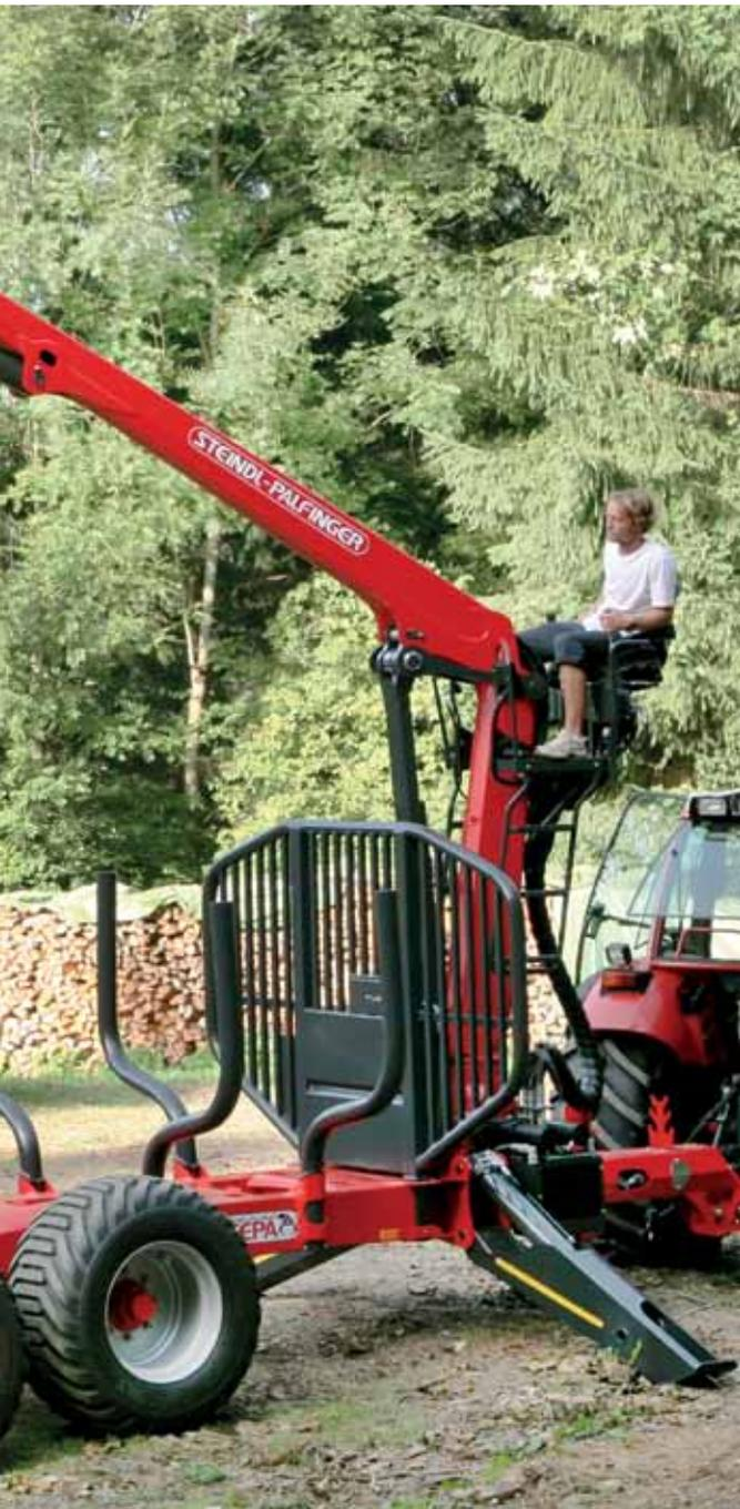
Die Elite von STEPA hat eine Reichweite bis zu 10m. Vor allem im steilen Gelände sind Krane mit großer Reichweite von entscheidendem Vorteil, wenn die Baumstämme nicht überall bis an den Forstweg heran gezogen werden können.
